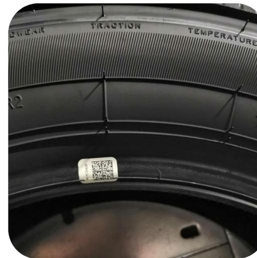
Перспективный вариант для маркировки продукции на производстве до вулканизации.
